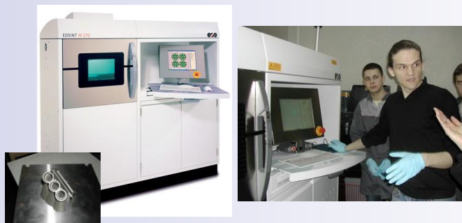
Установка для послойного синтеза деталей из металлических порошков (технология Direct Metal Laser Sintering (DMLS))
