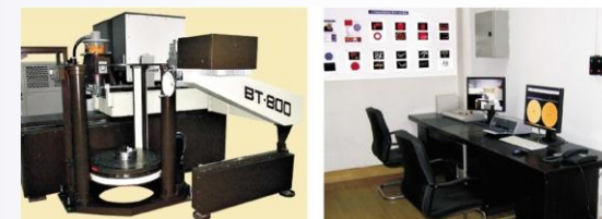
Компьютерный томограф для послойной проверки качества изготовления деталей
