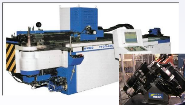
Трубогибный станок с ЧПУ ТГСП-40С
