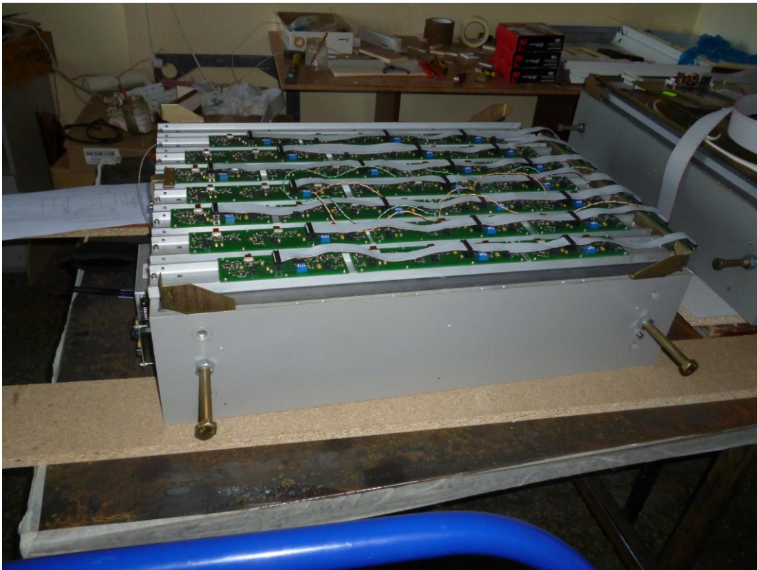
Рис. 2. Блок детектирования в процессе монтажа
