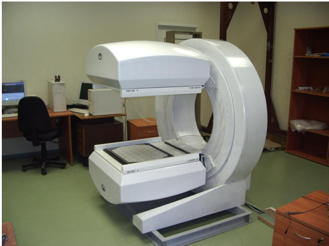
Рис. 5. Внешний вид гантри гамма-томографа с блоками детектирования. Вид сбоку
