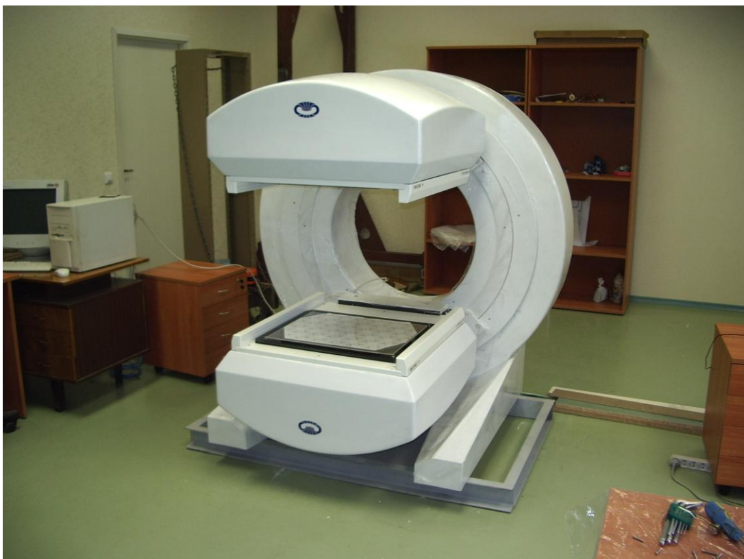
Рис. 4. Внешний вид гантри гамма-томографа с блоками детектирования. Вид спереди
