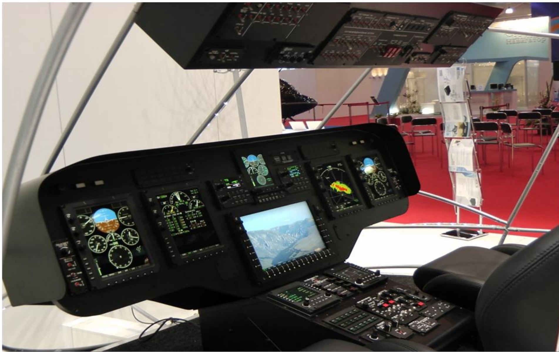
Макет кабины вертолета Ми-171А2 с оборудованием комплекса КБО-17 на выставке HeliRussia-2013
