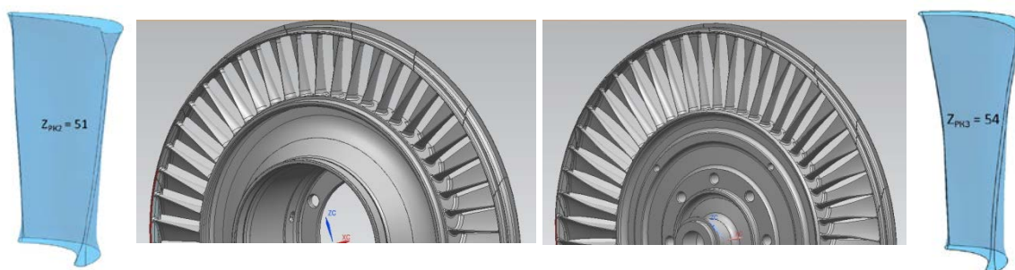
Рисунок 5 – Внешний вид блисков ТНД второй и третьей ступени.
