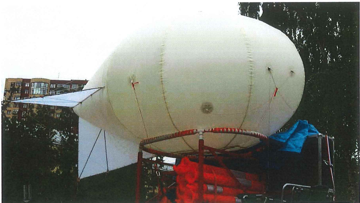
Стоянка аэростата на причальной опоре. Справа – транспортировочный контейнер.
