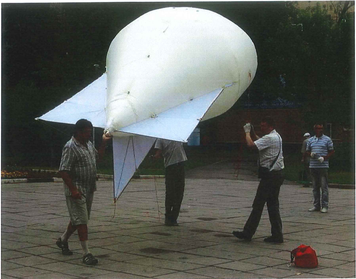
Подготовка к подъему. Справа на земле – балластный мешок с песком.
