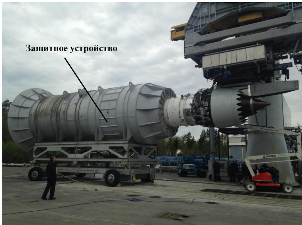
Рисунок 5 – Двигатель ПД-14 на открытом стенде ПАО «ОДК-Сатурн» с защитным устройством для испытаний на режимах обратной тяги
