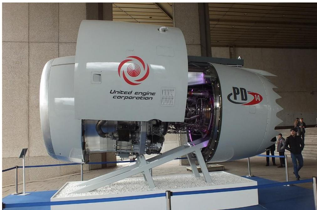
Рисунок 2 – Двигатель ПД-14. Реверсивное устройство сдвинуто назад - в положение обеспечения доступа при обслуживании двигателя
