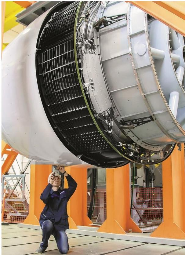
Рисунок 4 – Композитная решетка реверсивного устройства двигателя ПД-14
