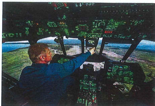
В кабине комплексного тренажера экипажа Ми-8АМТШ
