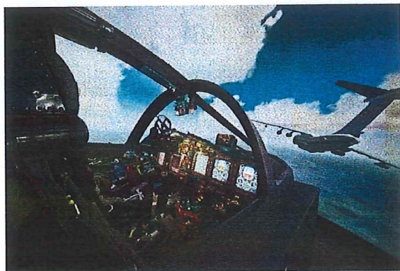
Кабина комплексного тренажера экипажа самолета Су-34
