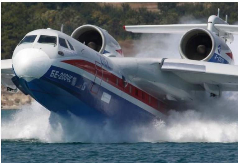
Самолет-амфибия Бе-200ЧС, обладая высокими летно-техническими характеристиками сухопутных турбореактивных самолетов, позволяет совершать взлеты и посадки на воду и, тем самым, значительно повысить эффективность выполнения специальных задач, где обычно требуется использование комбинации таких средств как: вертолеты, самолеты и корабли.
