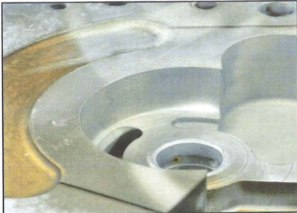
Рис. 3. Корпус маслонасоса после ремонта
