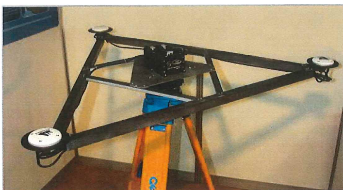
Рис. 2. Внешний вид экспериментального образца интегрированной навигационной системы на микромеханических датчиках.
