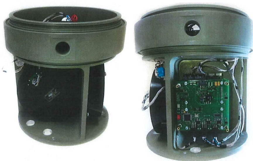
Рис. 1. Внешний вид экспериментального образца интегрированной навигационной системы на ВОГ.
