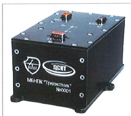
Рис. 2. Внешний вид экспериментального образца интегрированной навигационной системы на микромеханических датчиках.
