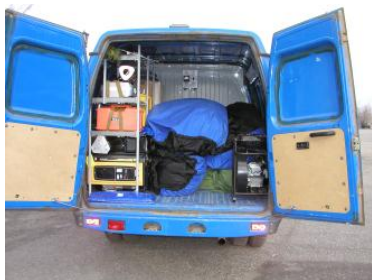
Рисунок 1а – МПК в комплектации с имитаторами Т-80 и СУО ЗРК Бук
