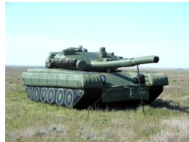
Рисунок 2 – полноразмерный макет Т-80
