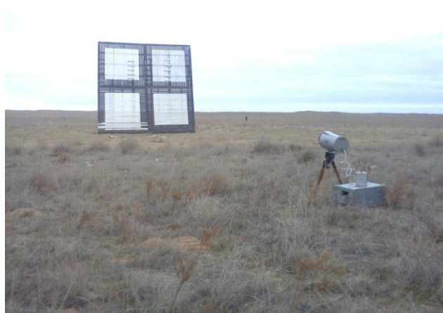
Рисунок 4б – использование СРЛ на мишени – щит
