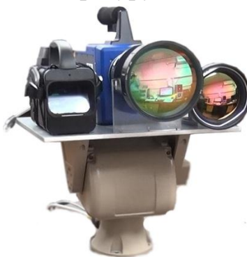
Рисунок 5б - ТП-система на платформе ОПУ
