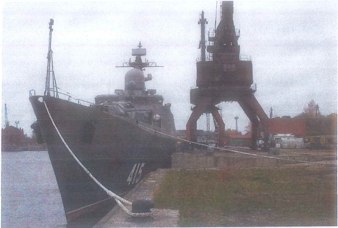
Рисунок 2 – Замеры уровней электромагнитных полей авианесущего корабля в ближней зоне (измеритель размещается на кране)
