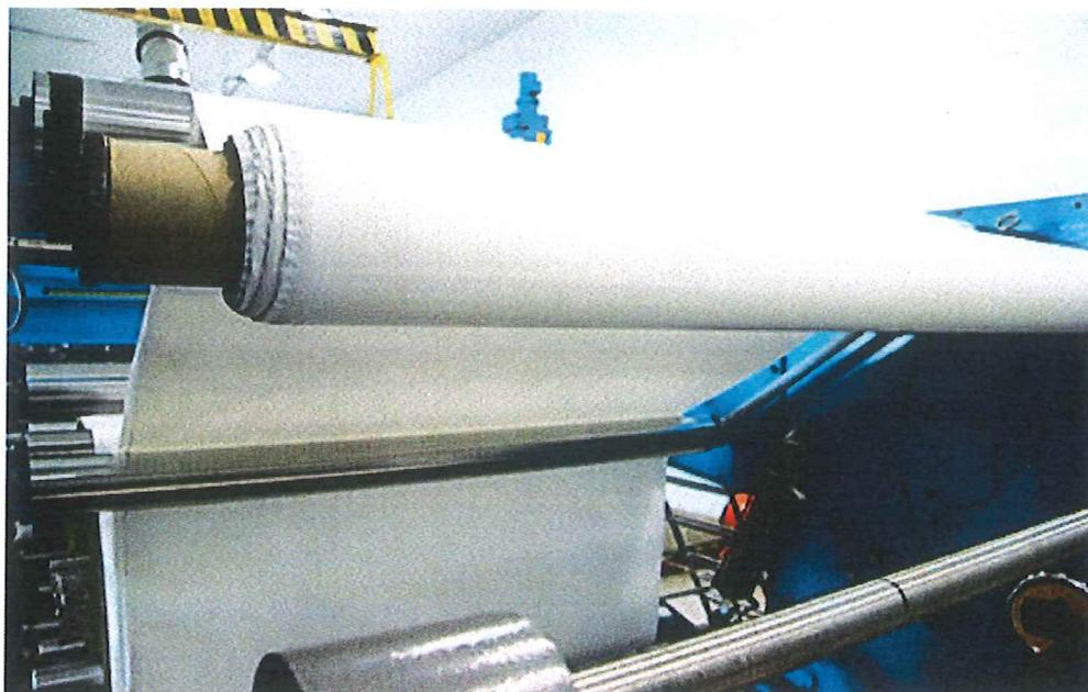
Новизна технологии заключается в подборе технологических параметров: давление прижимного вала, скорость движения материала и пленок, температура дублирующего вала, температура воды на охлаждающем валу, вследствие чего, можно получить материалы с набором новых свойств, что было и осуществлено при проведении работ по постановке на производство материалов ММТ марок МК, МБ, МО.
