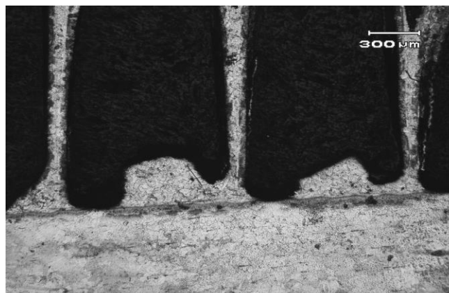
Рисунок 5. Макроструктура паянного соединения после пайки с технологическим экраном
