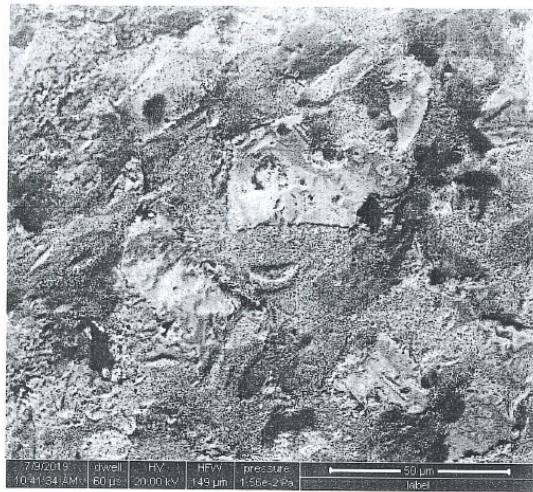
Фото 1. Характерный вид поверхности во внутренней полости лопаток на электронном микроскопе в режиме «сomp»
