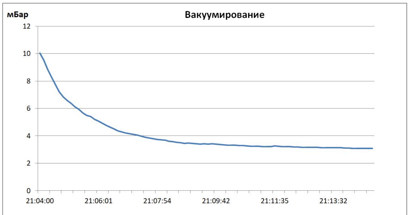
Рис. 4. График значений давления при проведении предварительного вакуумирования рабочей камеры с загруженными в составе корзины отливками.
