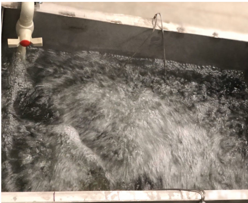
Рис. 13. Окончательная промывка лопаток в составе модульной корзины в барботируемой ванне.
