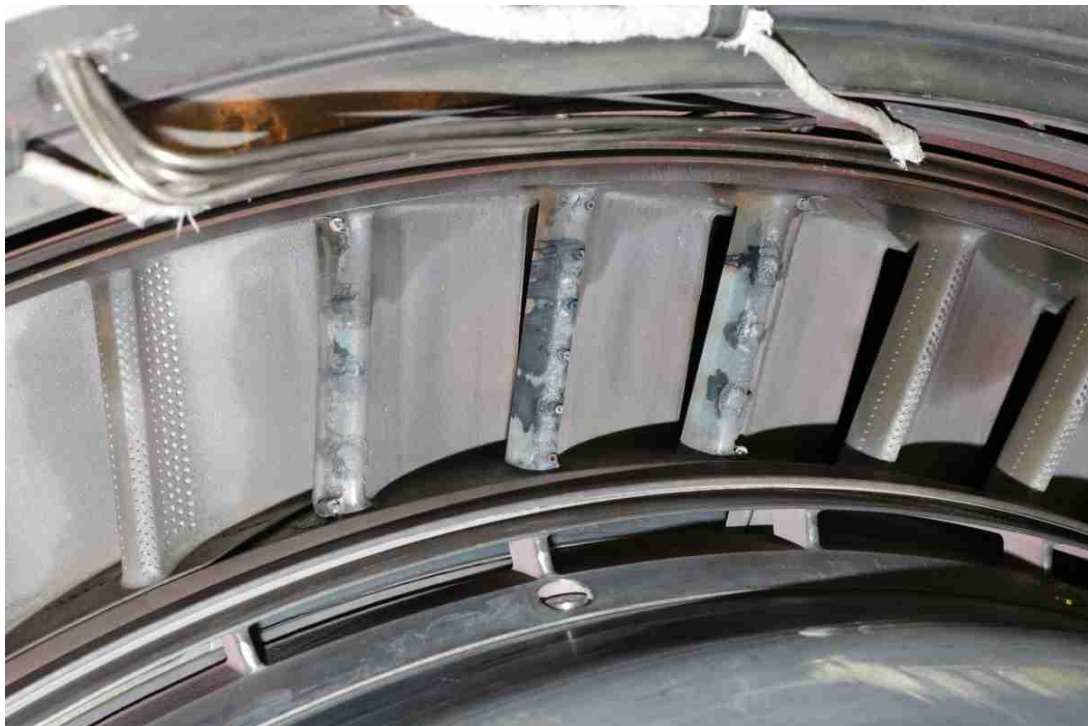
Рисунок 6 – Сопловой аппарат с препарированными лопатками
