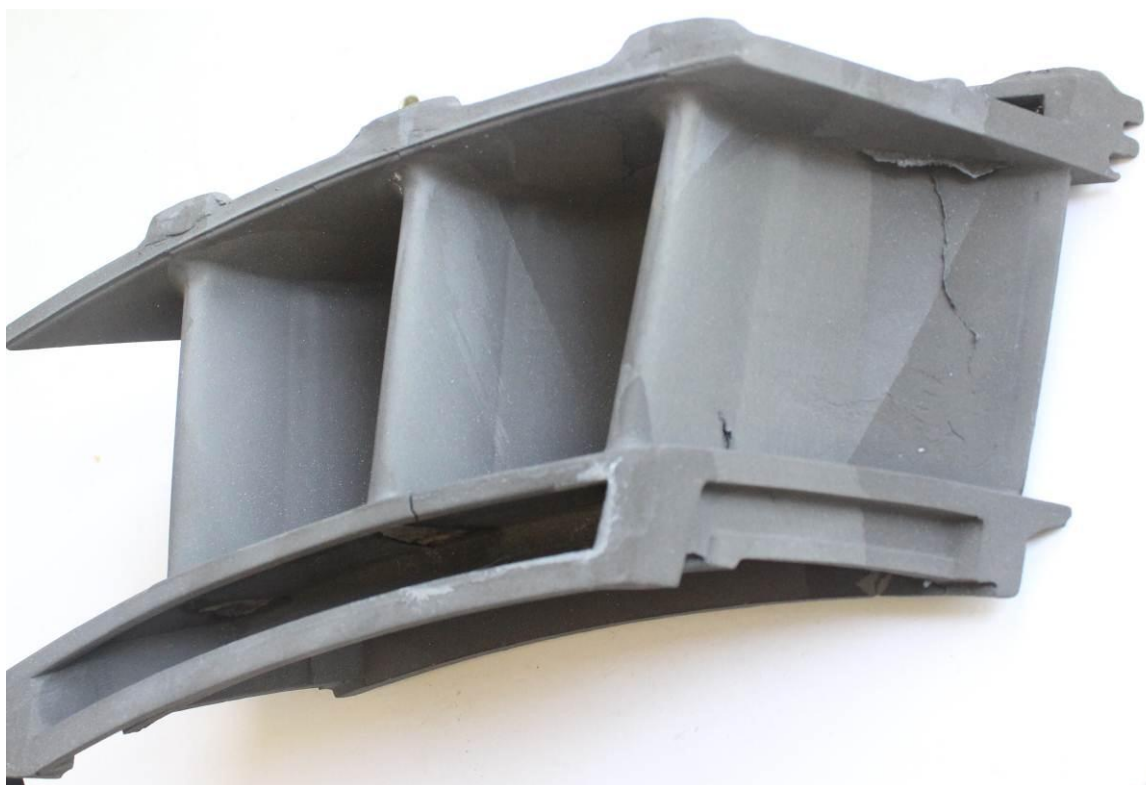
Рисунок 3 – Макроструктура блочных сопловых лопаток (перо)
