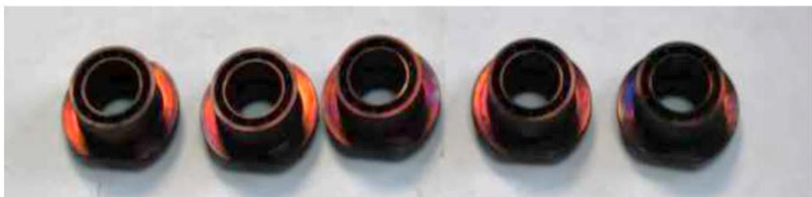
Рис. 2 Завихрители после испытаний
