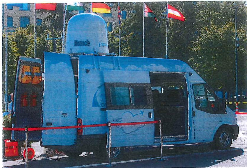
Рисунок 3 – Мобильный интегрированный метеорологический комплекс
