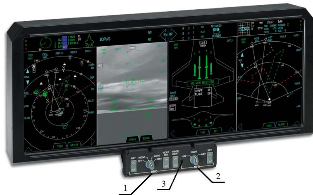
Широкоформатная система индикации, состоящая из двух совмещённых сенсорных экранов, устанавливаемая в F-35
