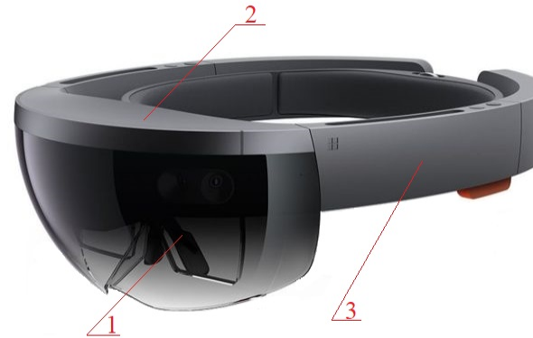
Очки HoloLens . 1 - защитное стекло, 2 - технологическая панель, 3 - корпус
