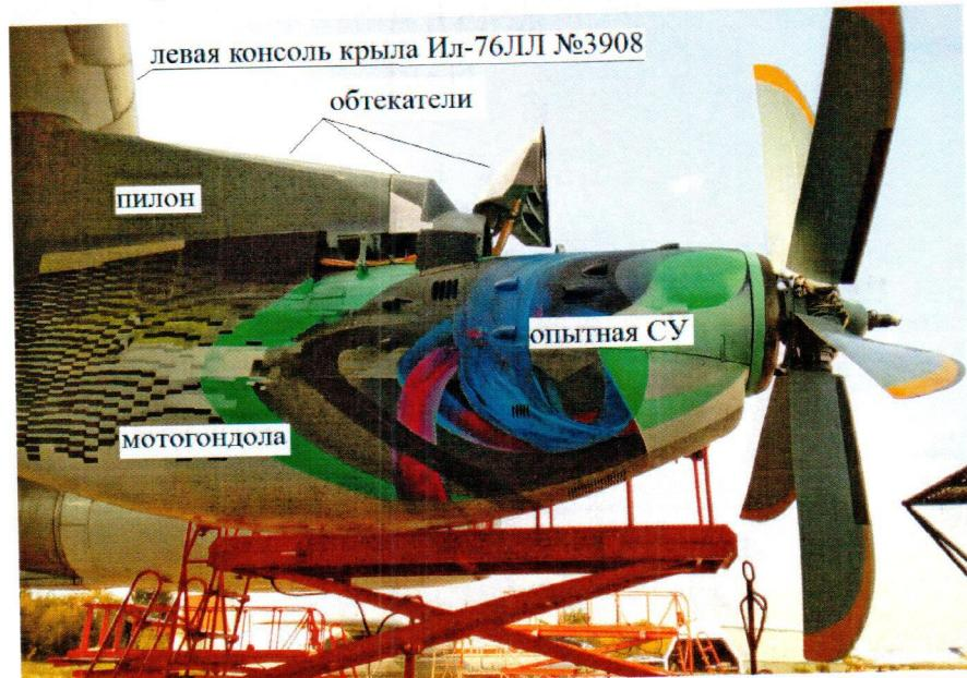
Рисунок 2. Схема подвески мотогондолы с опытной СУ на крыле Ил-76ЛЛ
