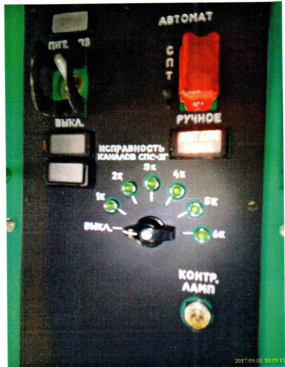
Рисунок 5. Панель управления средствами пожарной защиты опытной СУ на пульте бортинженера
