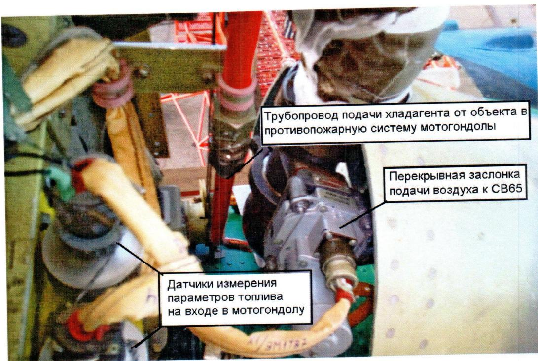
Рисунок 4. Трубопровод подачи хладагента в МГ, датчики измерения давления и температуры топлива на входе в МГ, заслонка системы воздушного запуска.
