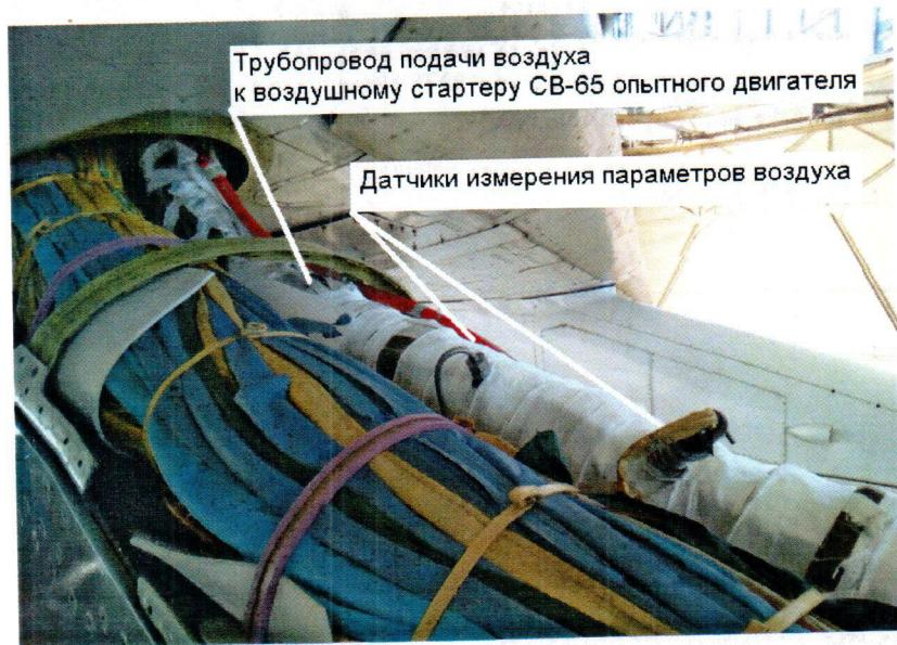
Рисунок 3. Коммуникации экспериментальных систем в пилоне опытной СУ №2 (со снятыми обтекателями).
