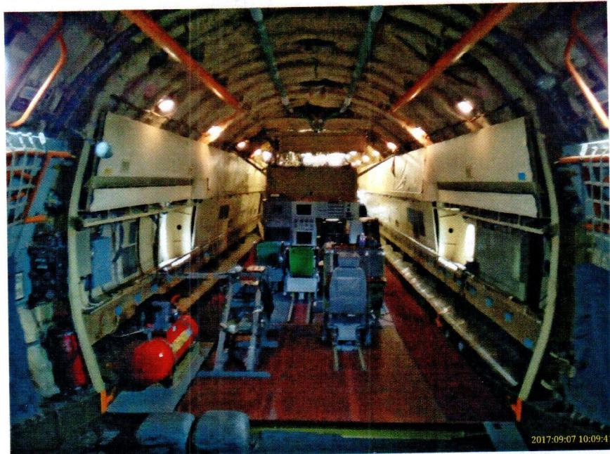
Рисунок 7 Пульты управления и контроля опытной СУ в грузовом отсеке ЛЛ.
