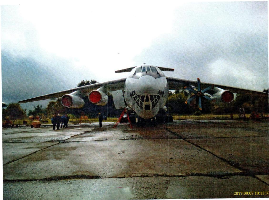
Рисунок 1. Летающая лаборатория Ил-76ЛЛ №3908 с опытной СУ в составе ТВД ТВ7-117СТ и ВВ АВ-112.
