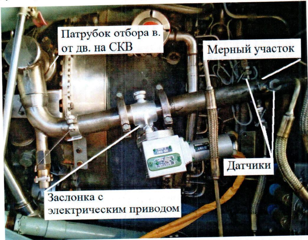
Рисунок 6 Система отбора воздуха от турбокомпрессора двигателя.
