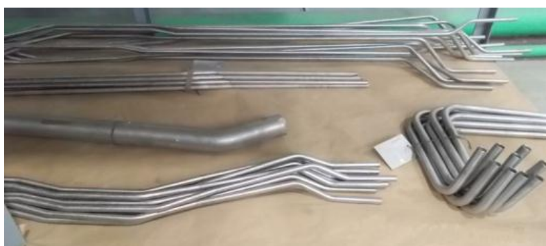
Рис. 12 – «Новая» конструкция труб с 1D
