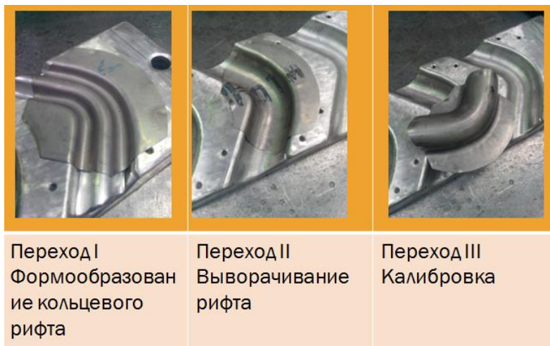
Рис. 2 – Конструкция оснастки и получаемая деталь для формования на прессе Я06017
