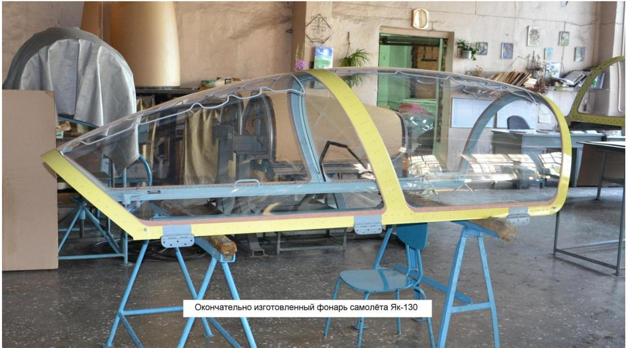
Окончательно изготовленный фонарь самолёта Як-130
