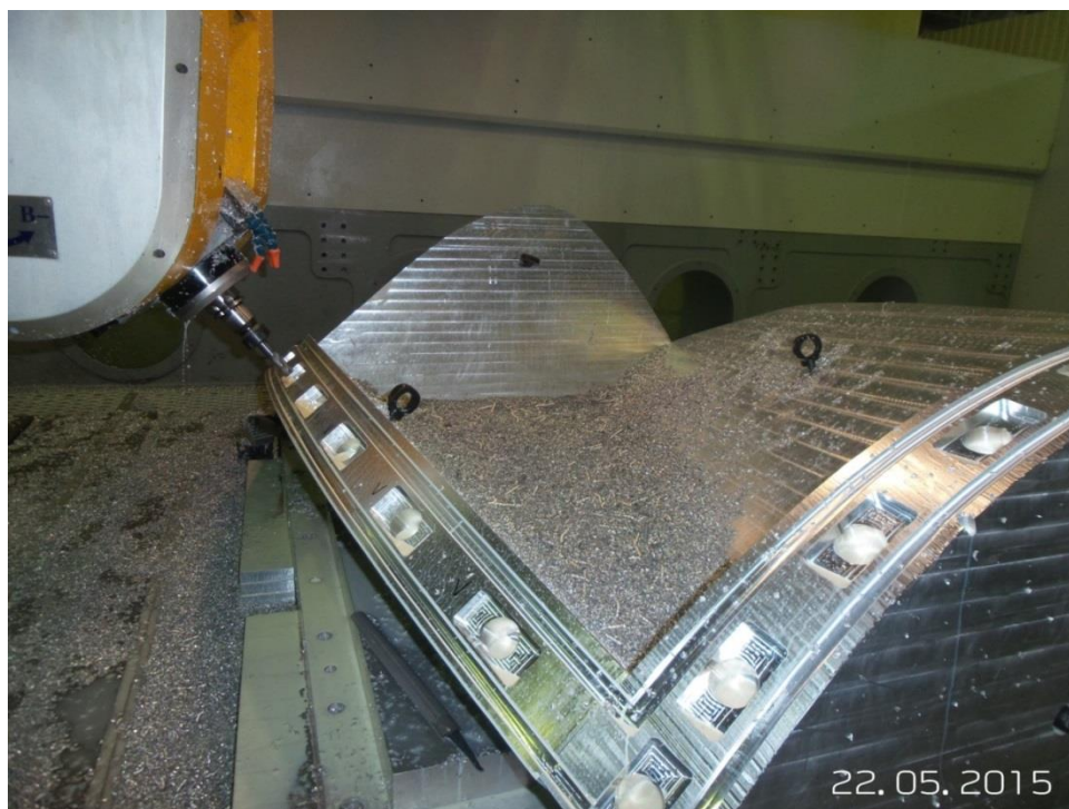
Рис. 11. Обработка пазов на обрабатывающем центре с ЧПУ S.F.Y. 5AX-6000
