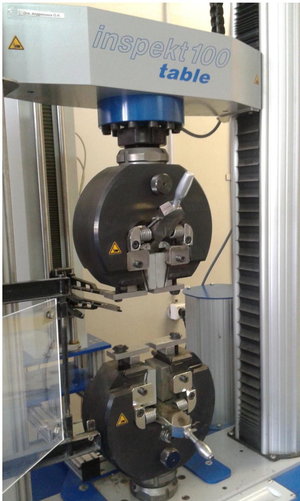
Рисунок 1 Приспособление для проведения испытаний на растяжение
