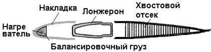
Схема сборки лопасти ЛНВ
