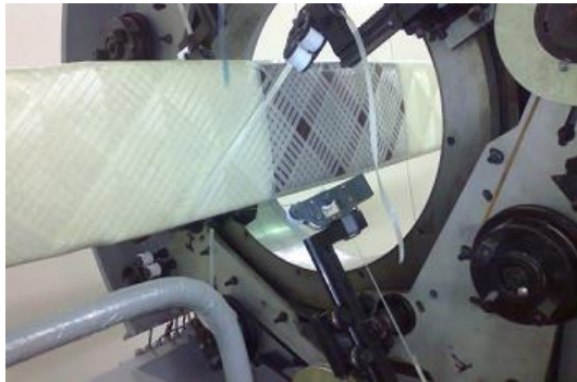
Изготовление лонжерона методом сухой спиральной намотки
