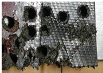
Основные дефекты обработки отверстий в ПКМ
