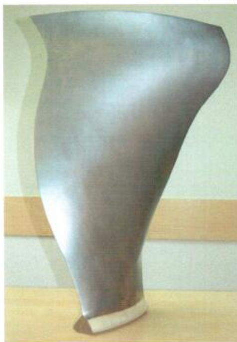
Рисунок 1 – Полая широкохордная рабочая лопатка вентилятора
