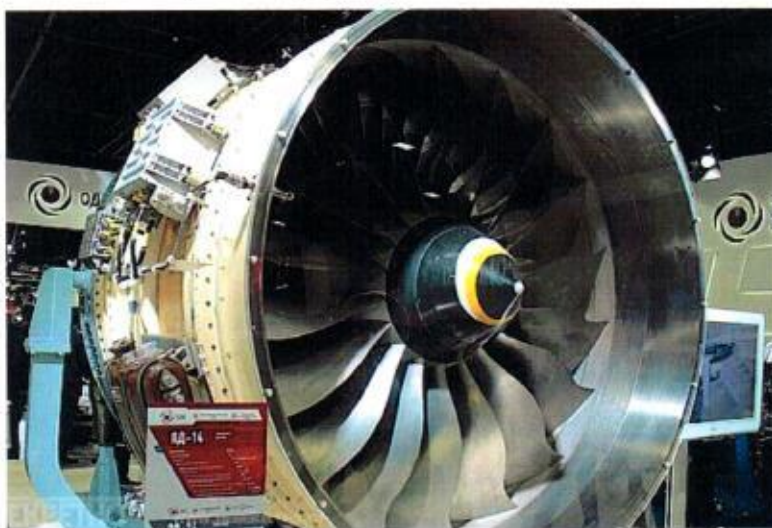
Рисунок 2 – Натурный образец дв. ПД-14 с полыми РЛ вентилятора на МАКС-2013
