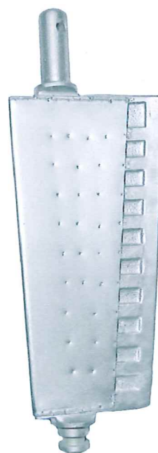
Лопатка после цикла ремонта
