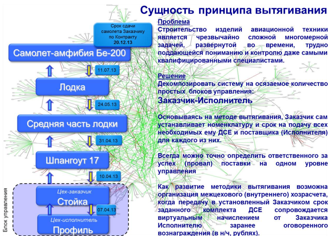
Рис. 1.4 Основная идея принципа «вытягивания» при построении производственной цепочки.
