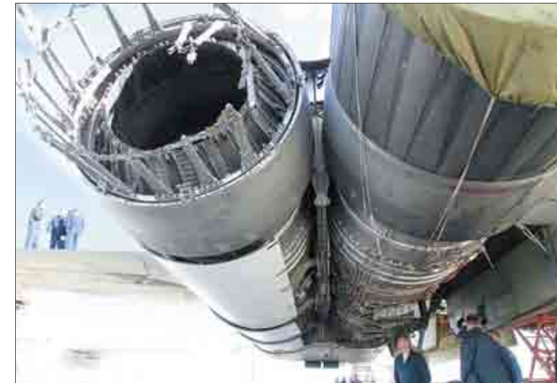
Обслуживание двигателей. На левом двигателе сняты створки сопла
