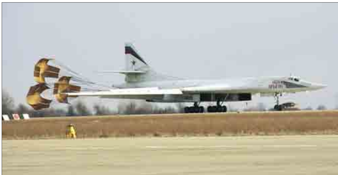
Три крестообразных парашюта значительно сокращают пробег при посадке
