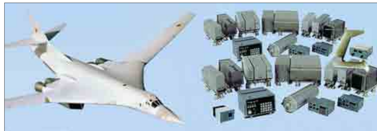
Штатный комплекс связи ТКС-1А. В состав комплекса входят средства радиосвязи, оборудование передачи данных, спецвычислители, аппаратура внутренней связи, коммутации, кодирования и помехозащиты информации, а также другие специальные устройства.
