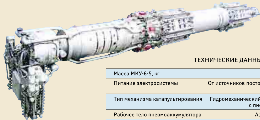
Универсальная многопозиционная катапультная установка МКУ-6-5У, предназначенная для самолетов Ту-95МС и Ту-160
