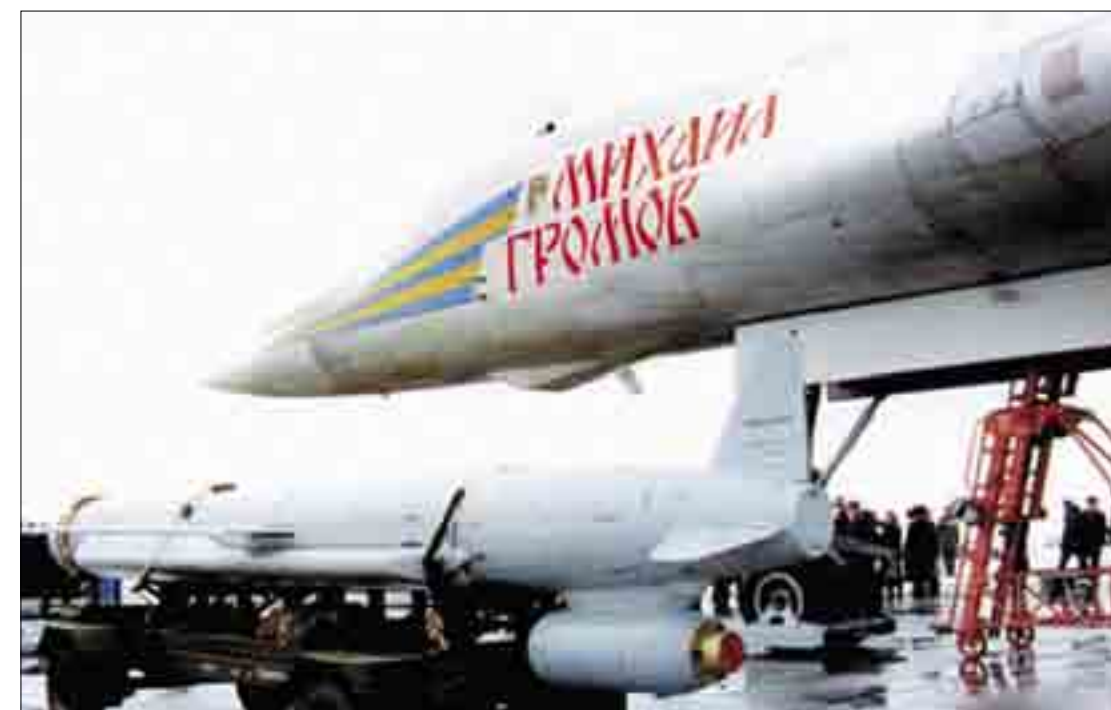
Крылатая ракета воздушного базирования (КРВБ) большой дальности Х-55СМ на транспортировочной тележке под серийным самолетом Ту-160 «Михаил Громов»
