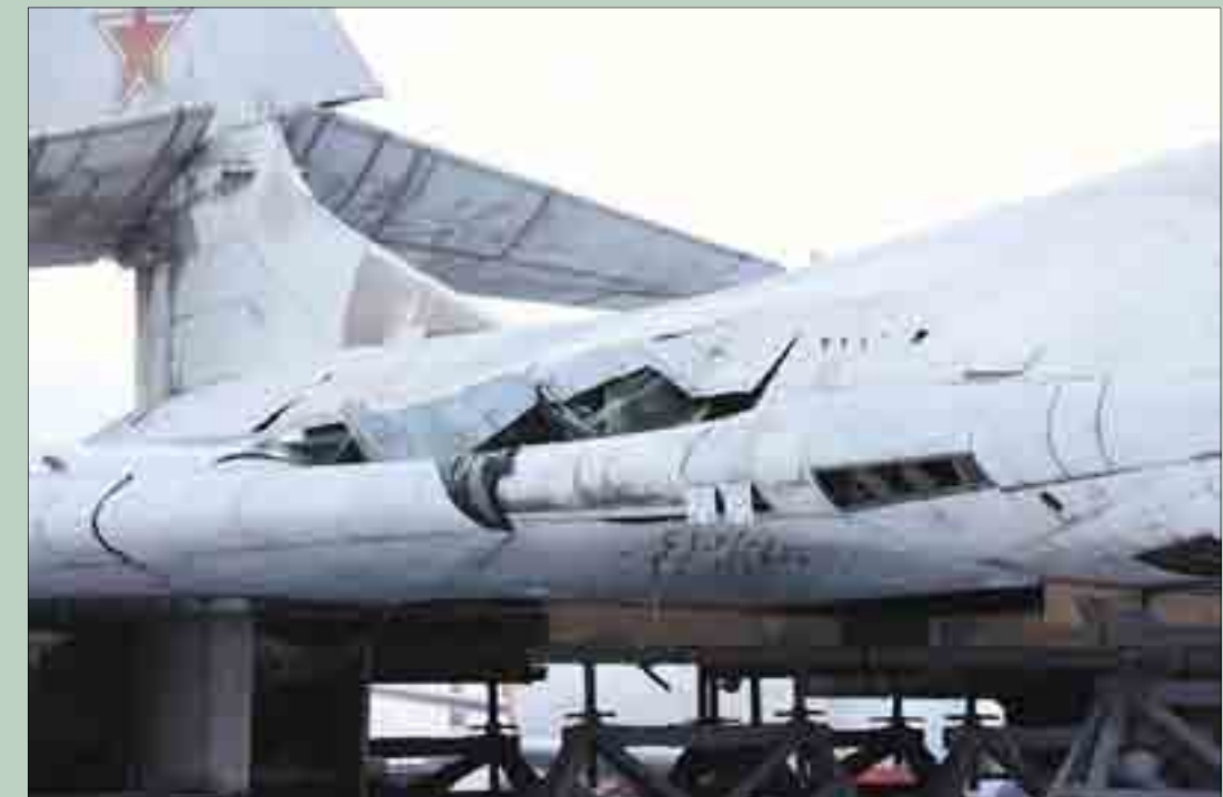
Ту-160 с серийным номером «1-01» с повреждениями конструкции, оставшимися после эксперимента по разрушению топливных баков № 1 и № 2, проведенного 01.11.2003 в целях подтверждения версии отказа клапана в дренажной системе нейтрального газа. По заключению Комиссии эта версия стала официальной причиной катастрофы самолета Ту-160 (серийный номер «701») в полете 18.09.2003
