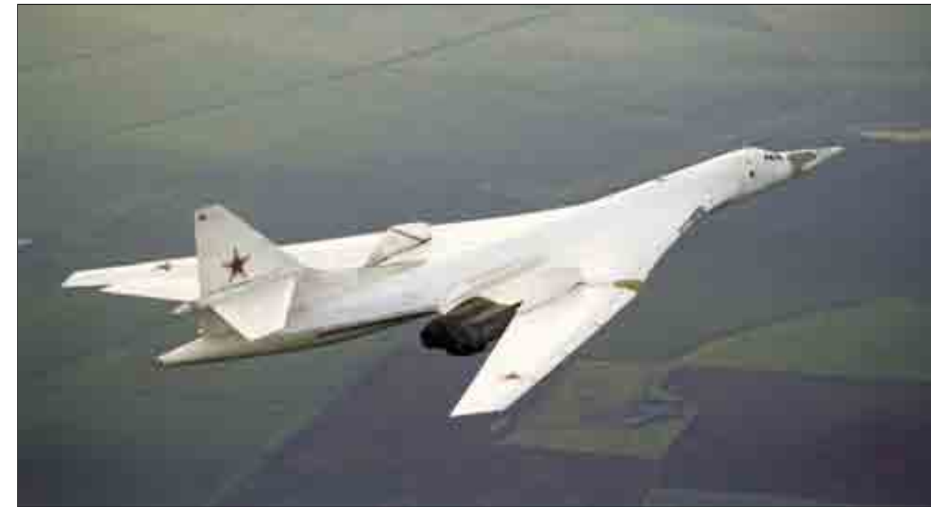
При полете на максимальной стреловидности аэродинамические гребни располагаются вертикально
