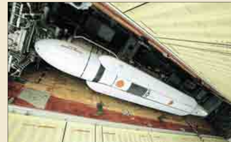
Крылатая ракета Х-55СМ, предназначенная для поражения целей на расстоянии до 3500 км, на МКУ-6-5У в грузовом отсеке самолета Ту-160
