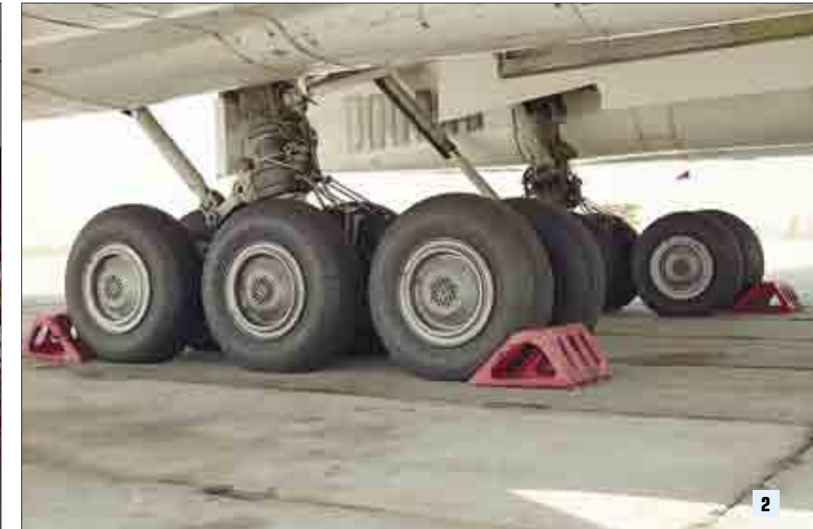
1. Передняя стойка шасси с противогрязевыми щитками и фарами для освещения ВПП 2. Основные опоры шасси
