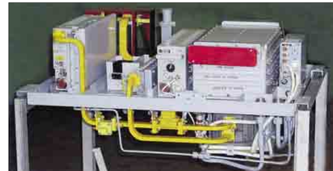
Усилитель мощности РЛС типа «Обзор»
