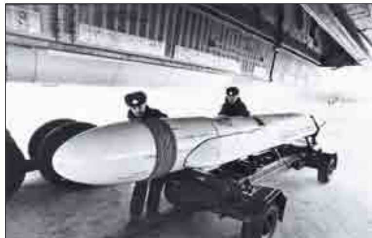
Наземный технический персонал подготавливает КРВБ типа Х-55СМ к подвеске на МКУ самолета Ту-160
