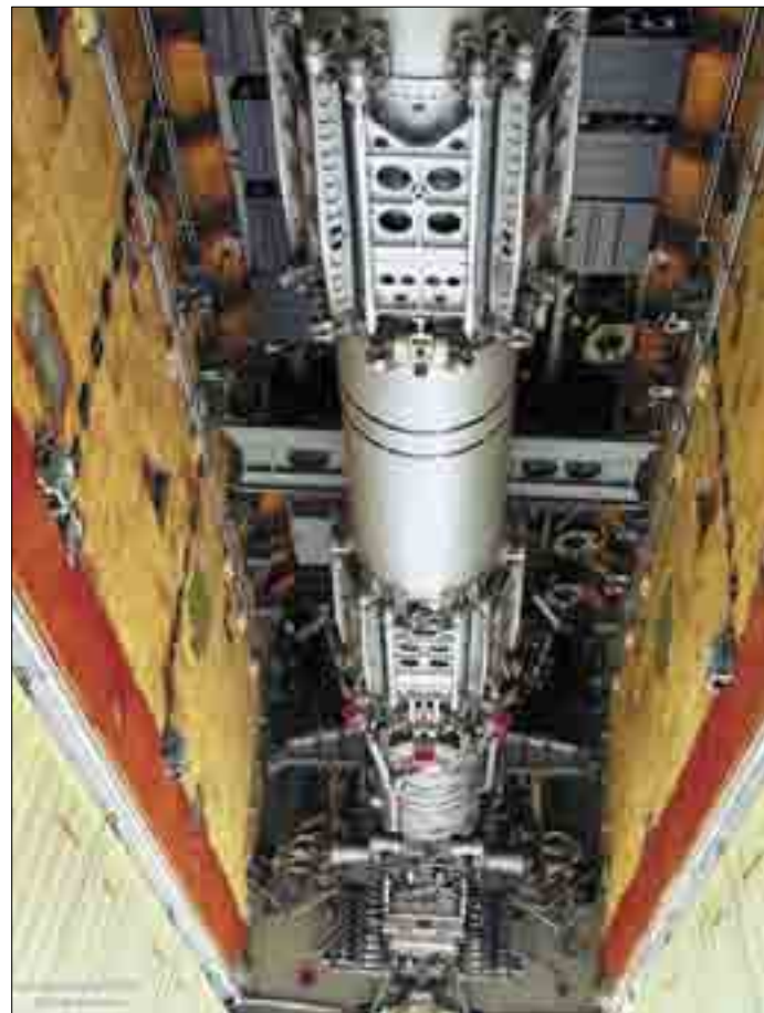
Отсек вооружения с многопозиционным катапультным устройством MKU-6-5U барабанного типа
