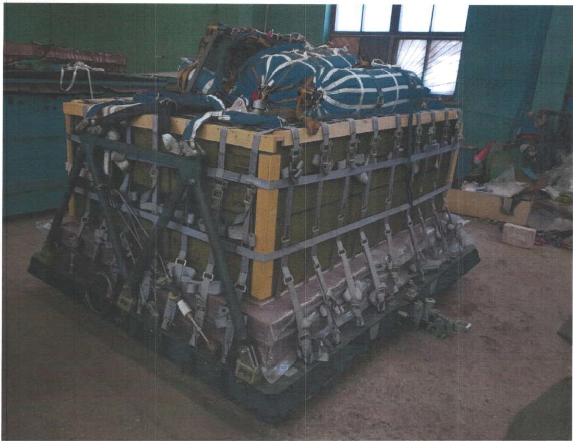
Управляемая планирующая парашютно-грузовая система УПГС-4000.
