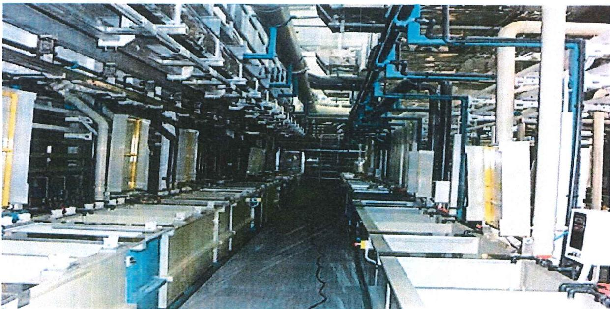
На предприятии построена бессточная гальваника замкнутого цикла компании Buffoli Impianti. Внедрены и используются более 30 видов гальванопокрытий:
