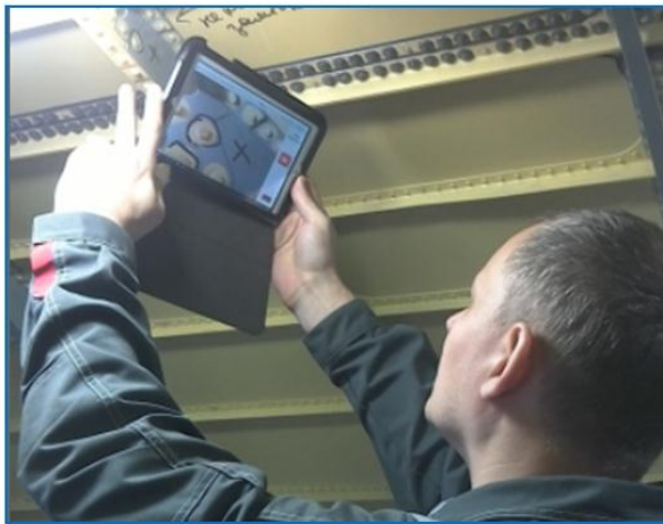
Рис.4 – Ввод данных о дефектах при проведении контроля
