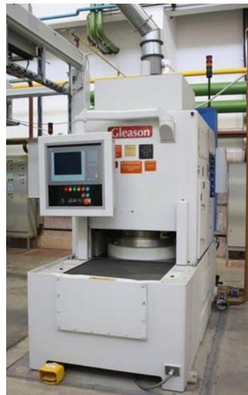
Пресс закалочный Gleason 537 (для закалки деталей диаметром до 650 мм.)
