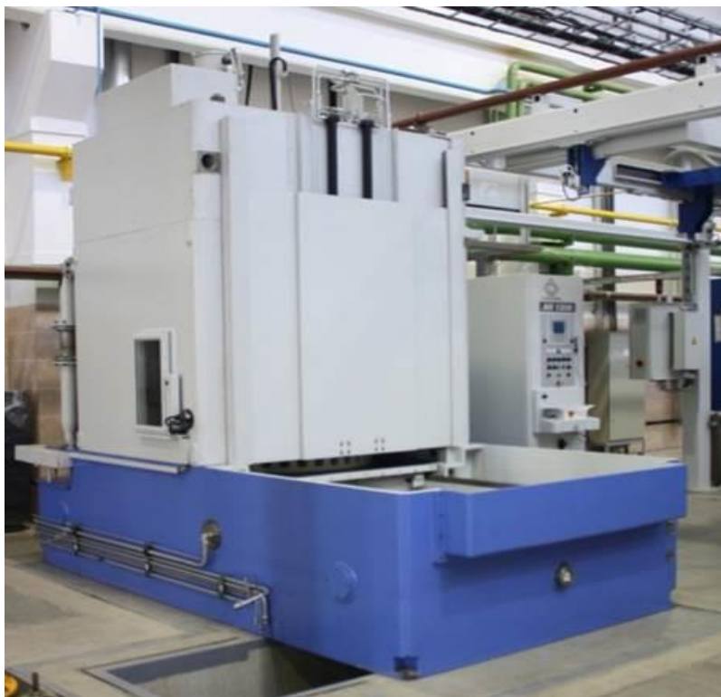
Пресс закалочный Klingelberg AH-1200 (для закалки деталей диаметром до 1200 мм.)
