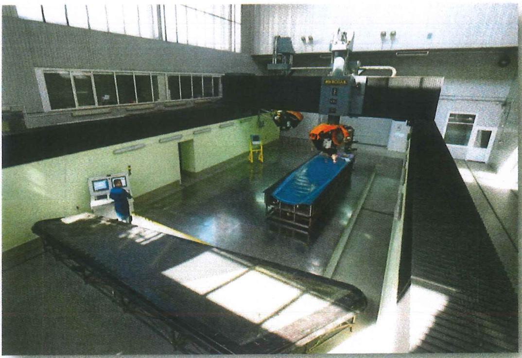
Рис.1. Установка для автоматизированной выкладки препрега (дает возможность изготавливать крупногабаритные детали с поверхностью двойной кривизны и с переменной толщиной в различных зонах).
