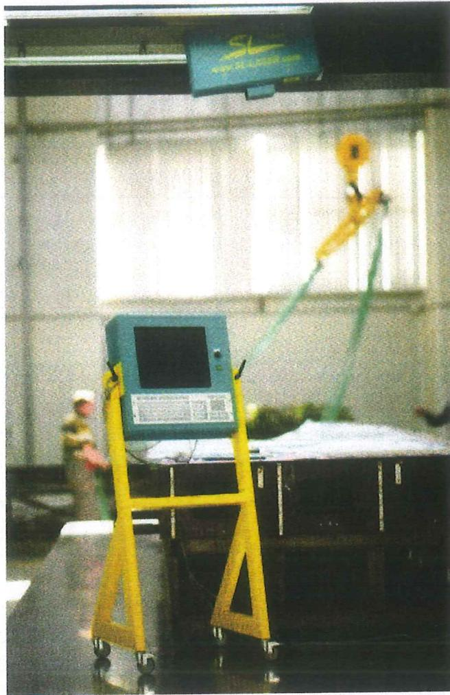
Рис.5. Лазерная проекционная система ProDirector, используемая при установке комплектующих в ходе сборки панелей.
