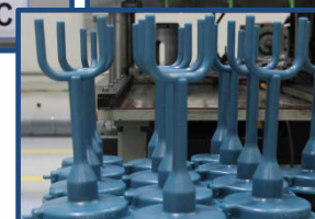
Изготовленные модели лопаток и элементы ЛПС
