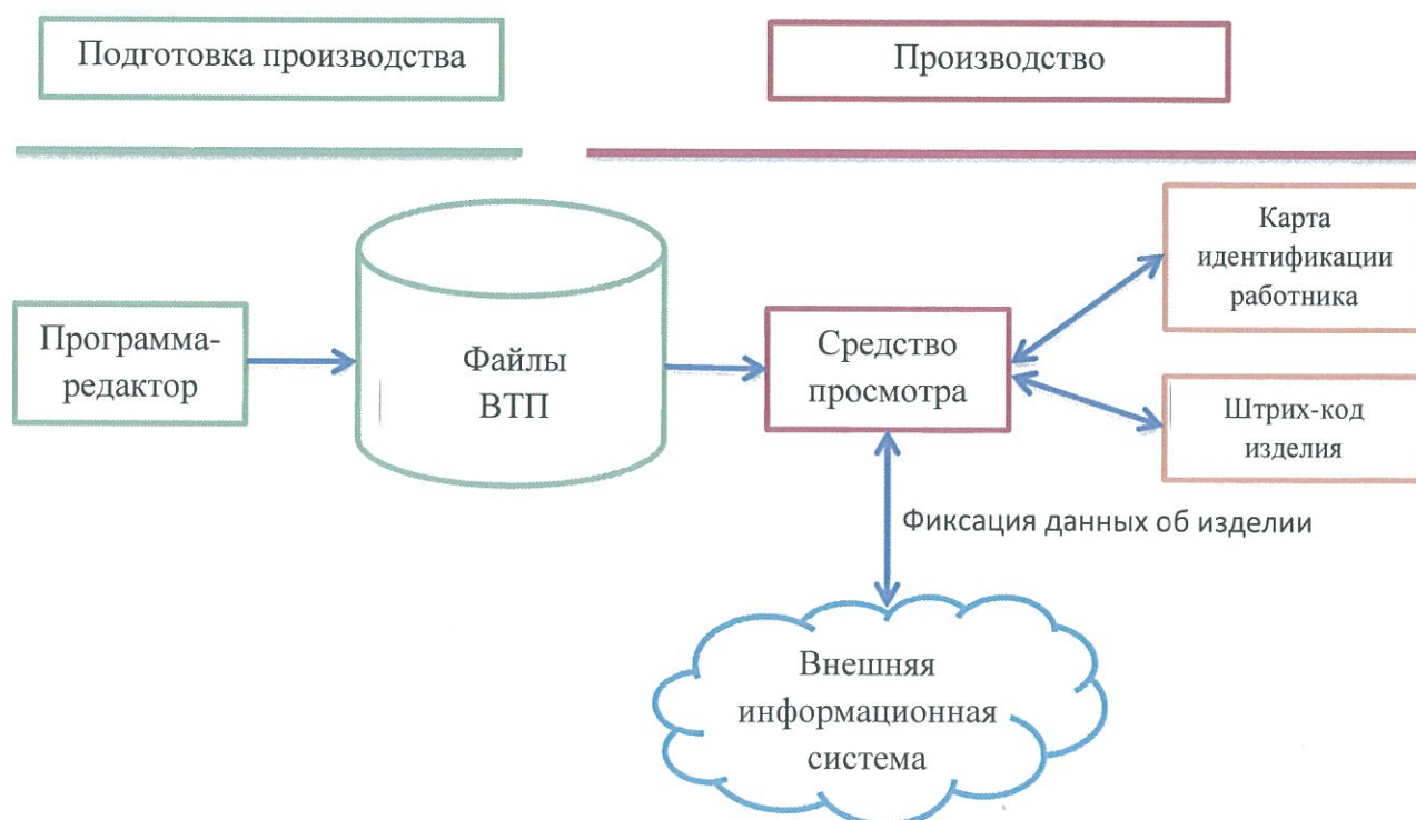
Рисунок 1. Схема подготовки и осуществления визуализации технологических процессов
