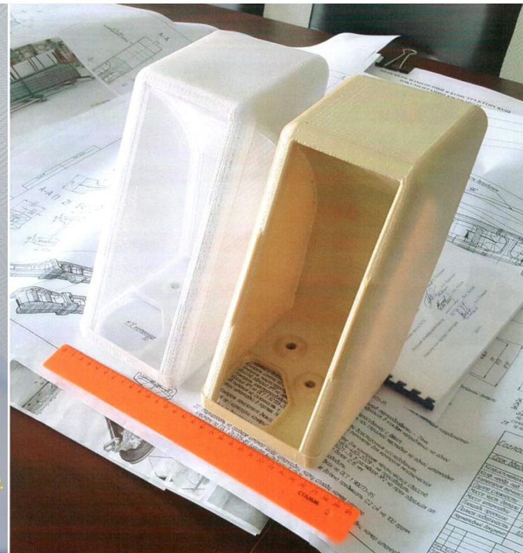
Выпускной патрубок обогрева вестибюлей (ранняя конструкция)
