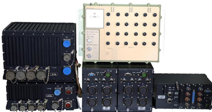
Рисунок 3– опытный образец системы диагностирования планера и ответственных узлов вертолета
