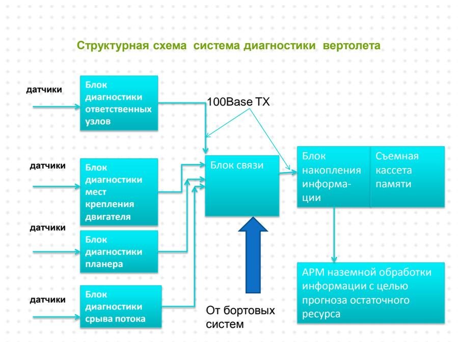
Рисунок 2– Структурная схема опытного образца системы диагностики и прогностики планера и ответственных узлов вертолета
