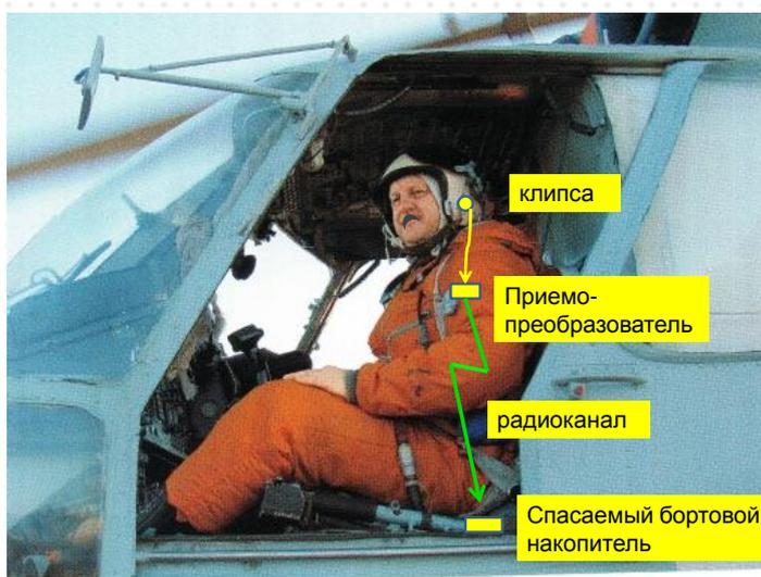
Рис.6– Размещение автономного модуля на борту вертолета.
