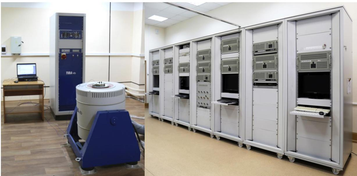
Рис. 5, 6 – Стендовое оборудование для полунатурного моделирования
